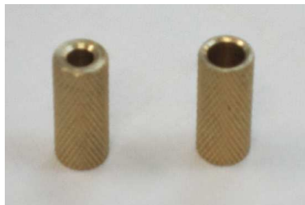
No.89 制動パイプ(新) No.50 制動パイプ
