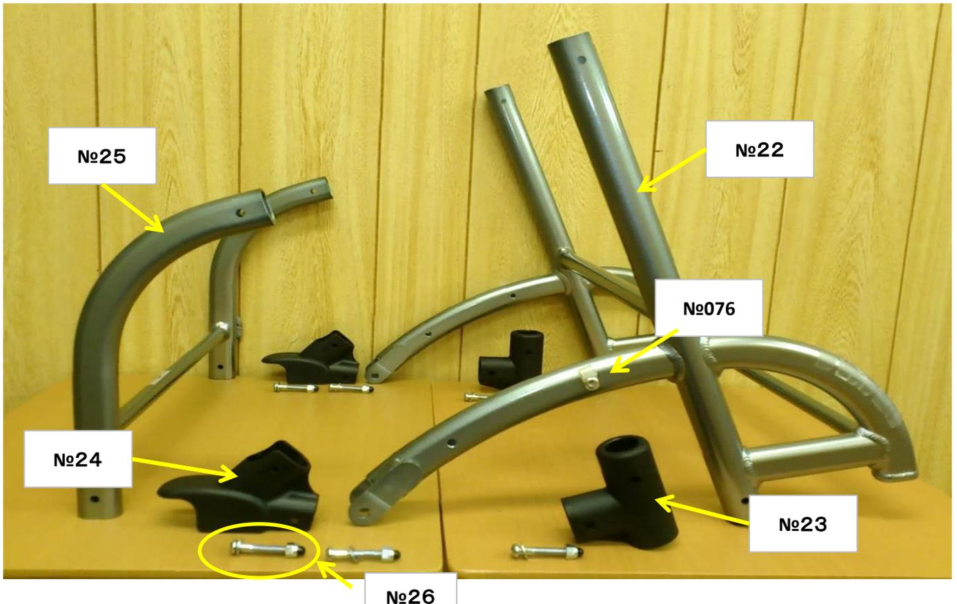
前輪側のフレームは2つのフレームと4つの樹脂パーツで構成されています。
