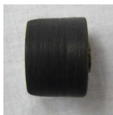
(ブレーキローラーの消耗)
