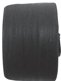
(消耗したブレーキローラー)
