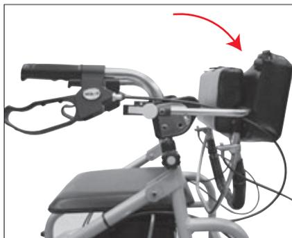
4 ブレーキ調整ボルトを締め、ブレーキワイヤーのあそびをなくします。(ブレーキ調整ボルトを反時計回りに回します)
